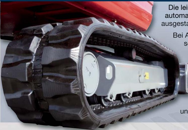
Die leistungsstarken Laufwerke sind mit einer automatischen, lastabhängigen Fahrstufenschaltung ausgestattet.
