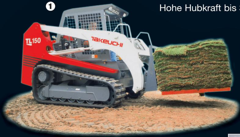
Hohe Hubkraft bis 3200 kg eröffnen flexible Einsatzmöglichkeiten.
