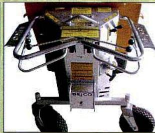
BEJCO Minidumper sind mit einfachen und leicht zu bedienenden Kontrollhandhebeln ausgerüstet, Bedienung ohne Veränderung der Handstellungen.
