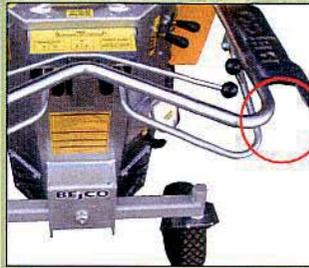
BEJCO Minidumper sind ausgerüstet mit Handschutzbügeln.
