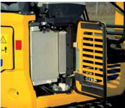
Rechte Wartungsklappe: einfacher Wartungszugang und leichte Reinigung der Kühler
