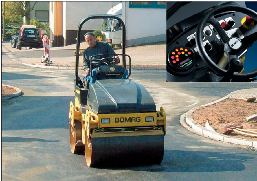
BW 120 AD-4: Schwingungsisolierter Fahrerstand; gute Sicht durch abgeschrägte Motorhaube und geneigte Stützen.
