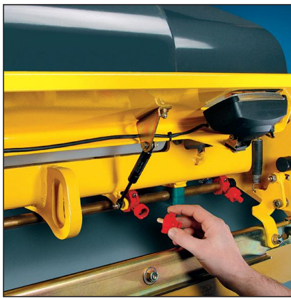
Praktische Details: Düsen sind windgeschützt hinter einer Blende und dennoch leicht zugänglich.
