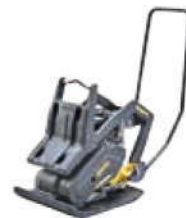
BP 20/50 Betriebsgewicht: 95 kg Zentrifugalkraft: 20 kN Arbeitsbreite: 500 mm
