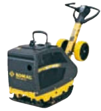
BPR 35/42 D Betriebsgewicht: 210 kg Zentrifugalkraft: 35 kN Arbeitsbreite: 420 mm
