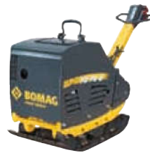
BPR 70/70 D Betriebsgewicht: 580 kg Zentrifugalkraft: 70 kN Arbeitsbreite: 700 mm
