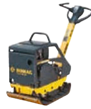
BPR 25/50 D Betriebsgewicht: 155 kg Zentrifugalkraft: 25 kN Arbeitsbreite: 500 mm
