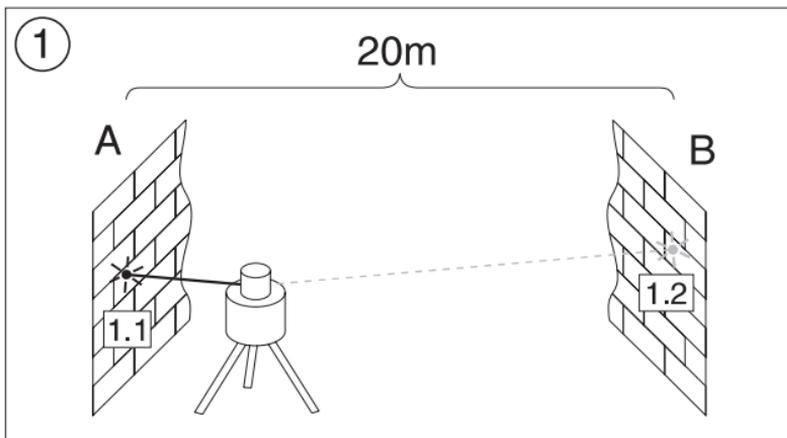
Nun plazieren Sie das Gerät nahe der Wand B. Richten Sie den Laserstrahl des nivellierten Gerätes in X-Achsen-Richtung zur nun nahen Wand B, so daß genau die zuvor markierte Höhe (aus der Messung von Wand A aus) realisiert ist. Drehen Sie das Gerät um 180°, nivellieren und markieren Sie die Strahlmitte an der Wand A. Die Differenz (h) der beiden hier markierten Punkte ergibt nun die tatsächliche Geräteabweichung.
