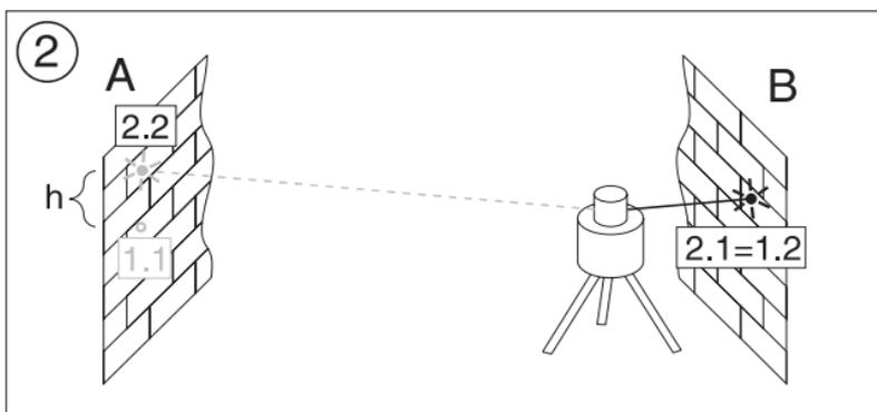
Liegt das Gerät an der Grenze der Werksgenauigkeit ( $\pm 1,5 \text{ mm}$  auf 10 m) beträgt bei  $20 + 20 = 40 \text{ m}$  die maximale Abweichung von der Nulllage 6 mm.
