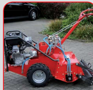
HF 700 DUO: Profi-Umkehrfräse mit Gitterwalze
