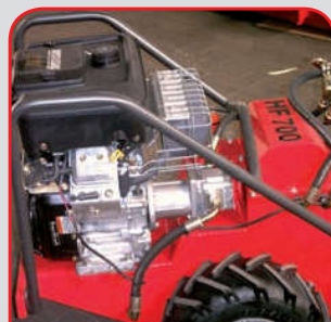
Rammschutz und Kranverladeöse
