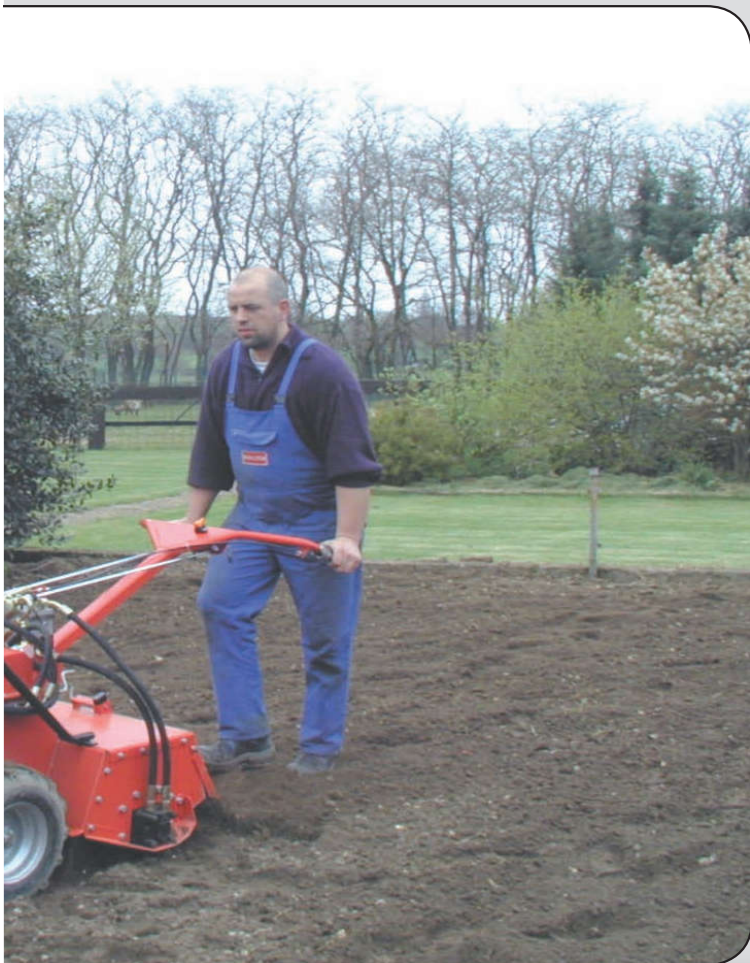
HF 700 DUO: Profi-Umkehrfräse mit Gitterwalze
