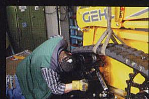
Vordere Radnabe ausrichten und ebenfalls anziehen. Alle Radmuttern bis 258 Nm festdrehen.
