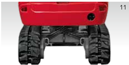
LAUFWERKS BREITE 980 MM
