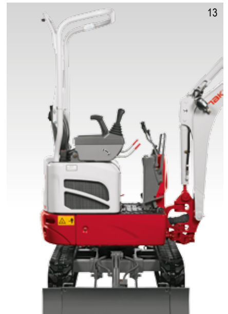
MIN. HECKÜBERSTAND BEI LAUFWERKSBREITE 1.020 MM
