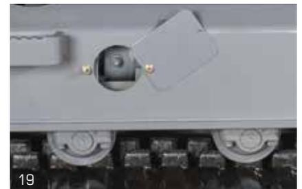
VOLLAUTOMATISCHE HYDRAULISCHE KETTENSPIANNUNG
