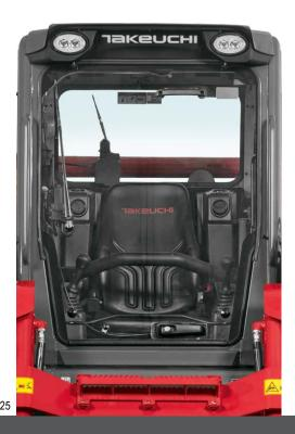
Die Kabinentür verfügt über einen Scheibenwischer und ist nach oben und innen einziehbar: Beschädigungen durch den Hubarm sind somit ausgeschlossen.
