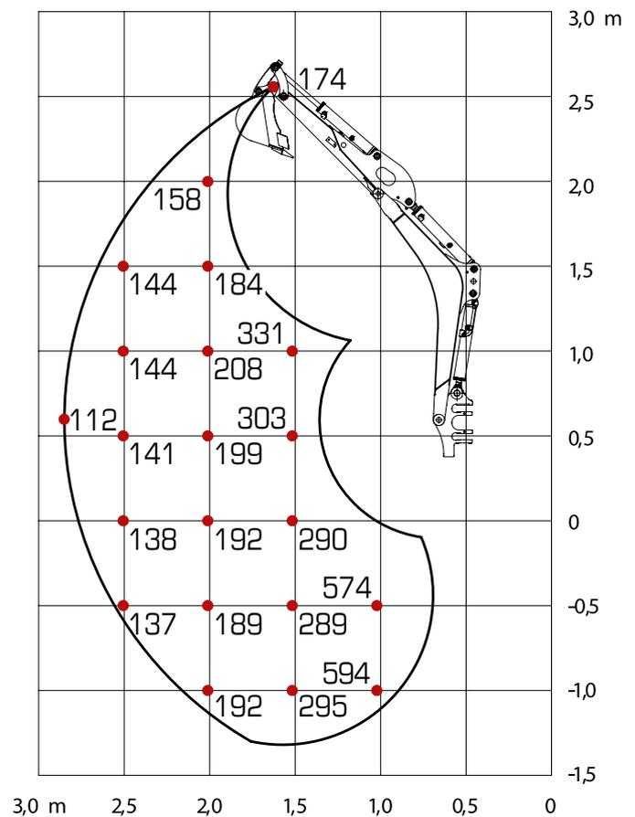
Die Hublasten in den Grafiken betragen bis zu 87 % der hydraulischen Hublast bzw. bis zu 75 % der Kipplast.
