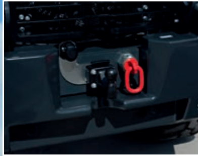
Kugelkopfkupplung mit 13-poliger Steckdose (Option)
