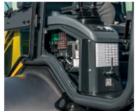
Seitliche Wartungsklappe für schnellen Wartungszugang
