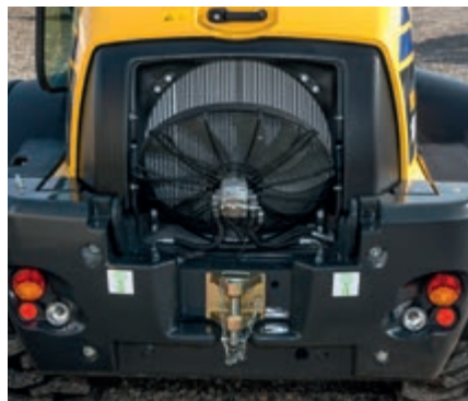
Kippbarer Kühlerlüfter für bequeme Reinigung
