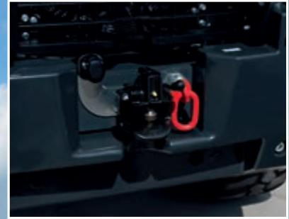
Automatikkupplung mit 13-poliger Steckdose (Option)
