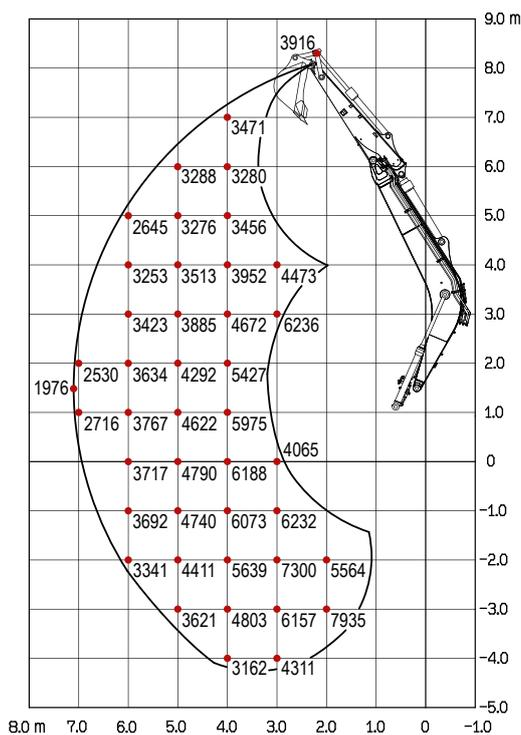
Die Hublasten in den Grafiken betragen bis zu 87% der hydraulischen Hublast bzw. bis zu 75% der Kipplast. Die Werte sind in Kilogramm angegeben – ohne Powerlift. Technische Änderungen vorbehalten.
