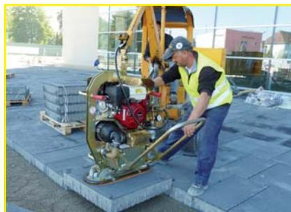
**POWERJET PJ-1650**, bis 1650 kg, hydraulisch oder mit Benzinmotor angetrieben, das Power Gerät für stark poröses Greifgut
