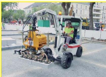
**SH-1000-MINI-H, B oder E**, Lastklasse bis 1000 kg, hydraulisch, über Benzinmotor oder elektrisch angetrieben, für leicht poröses Greifgut
