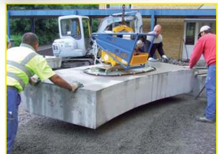
**SH-2500-UNI-B**, der bullenstarke Klassiker, seit 20 Jahren im Programm, bis 2500 kg, angetrieben über Benzinmotor
