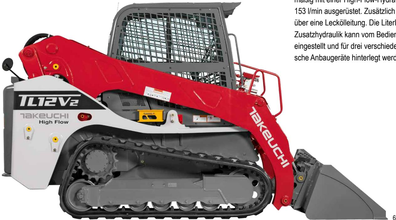
Die Takeuchi Laderaupe TL 12 V2 ist serienmäßig mit einer High-Flow-Hydraulik mit 153 l/min ausgerüstet. Zusätzlich verfügt sie über eine Leckölleitung. Die Literleistung der Zusatzhydraulik kann vom Bediener einfach eingestellt und für drei verschiedene hydraulische Anbaugeräte hinterlegt werden.
