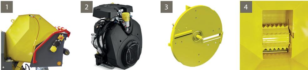
1- EINFÜLLTRICHTER KLAPPBAR für den Transport.
