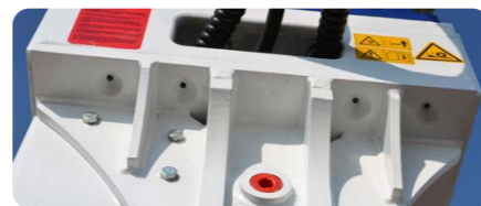
▲ Wasserbedüsung zur Staubbekämpfung (optional)
