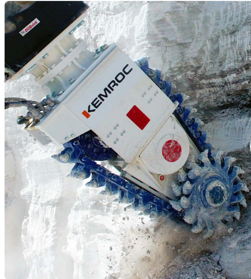
▲ eine EK 100 beim Abbau von Gips
