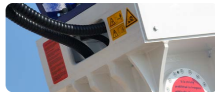
▼ spezielle Konsole zum Schutz der Hydraulikschläuche
