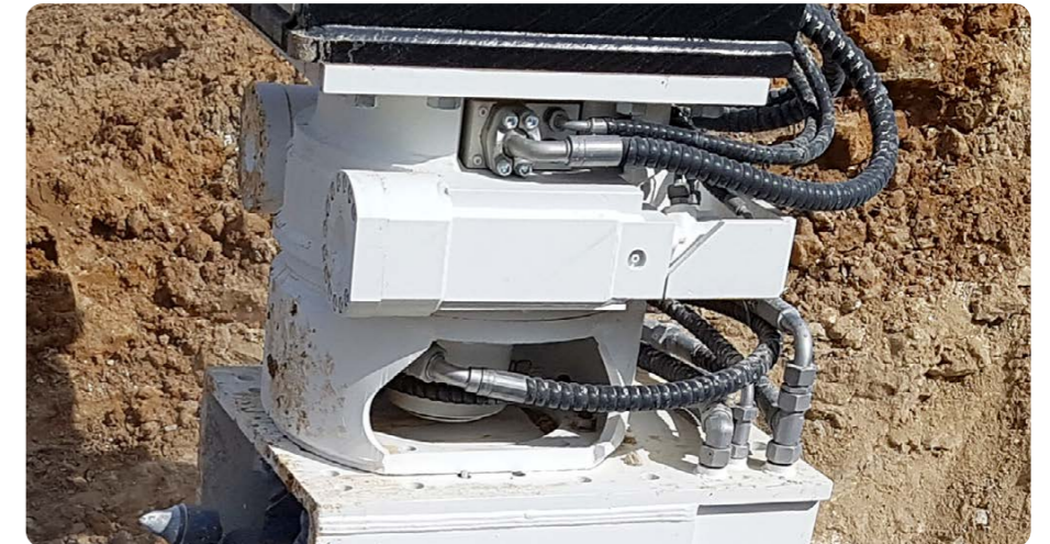
▲ Ein Rotationsmodul KRM 70 erweitert dank endlos drehender Rotation das Einsatzspektrum einer Anbaufräse.
