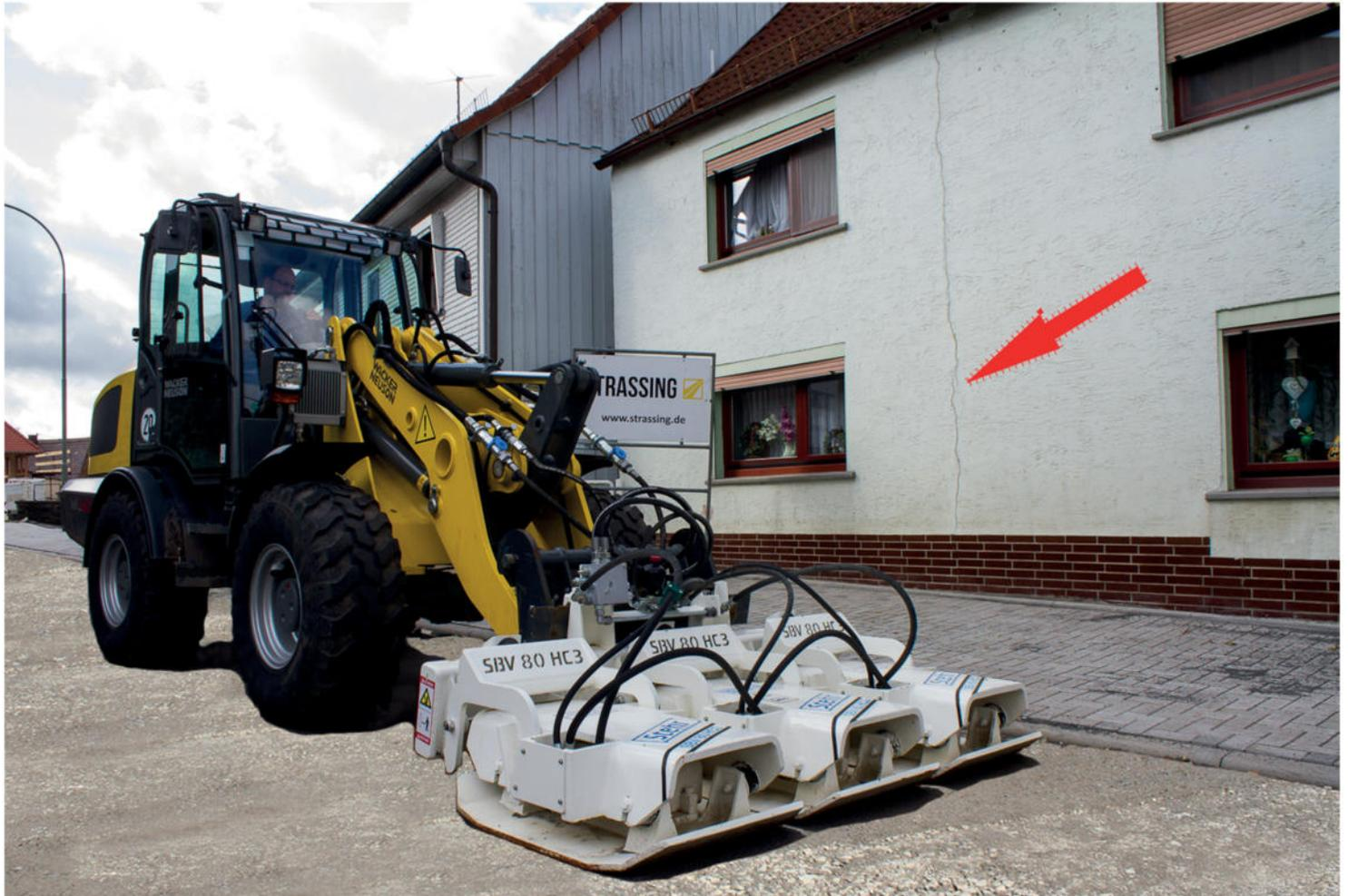
Unter der Aufsicht von Hessen Mobil wurden bei Schütthöhen von 30 cm 0 > 32 Basaltkörnung bereits nach zwei Übergängen Messergebnisse erreicht, die weit über den geforderten Werten lagen. Und das alles ohne merkbare Schwingungen, wie durch den „Stehr'schen Wasserglastest“ eindrucksvoll dargestellt wurde.
