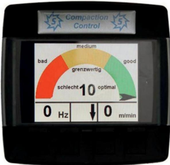
Damit können unnötige oder zu langsame Überfahrten vermieden werden, da der Maschinist die Fahrgeschwindigkeit immer optimal dem Verdichtungsergebnis anpassen kann. Damit sind enorme Einsparungen möglich. Es werden weniger Schadstoffe und CO<sub>2</sub> erzeugt. Ab 2016 werden alle Plattenverdichter mit dem neuen System ab Werk ausgerüstet. Unsere Kunden sind somit für die Zukunft gerüstet, um Abläufe bei der Verdichtung kostengünstiger und effizienter zu gestalten.
