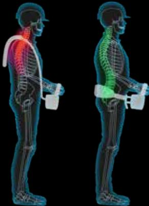
Ergonomie ist einer von vielen Vorteilen beim ferngesteuerten Abbruch. Brokk geht mit SmartRemote™ noch einen Schritt weiter und verbessert die Produktivität und den Bedienkomfort. Ein spezieller Tragegurt verteilt den Druck von den Schultern auf die Hüfte und reduziert so Müdigkeit und Rückenprobleme.
