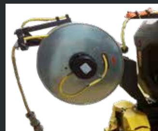
**Kabelrolle** Federzugtrommel für eine optimale Handhabung des Stromkabels.
