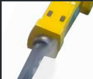
**Wassersprühdüse** am Hammer zur Staubbündung.
