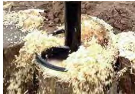
Die Schneiden machen mit jeder Umdrehung einen frischen Schnitt und hobeln das Holz in kleinen Spänen ab.
