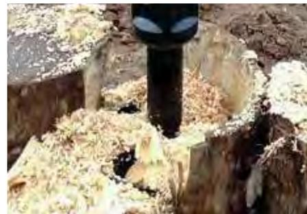
Nachdem der Fräsbohrer tief genug geschnitten hat, kann eine neue, überlappende Position angesetzt und die Prozedur wiederholt werden, bis der Stumpf vollständig entfernt ist.
