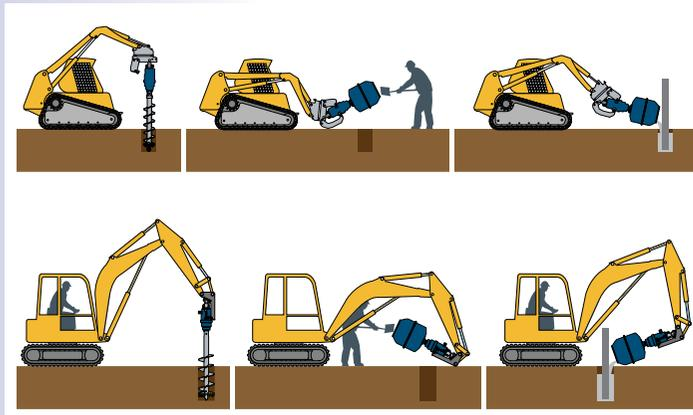
Ideal für Zaunbauer – dank der Mischeraufhängung mit Auflage kann die Bohrschnecke schnell gegen eine Mischtrommel ausgetauscht und mit dem vorhandenen Bolzen verriegelt werden. Nach dem Mischen lässt sich die Trommel mühelos wieder durch die Bohrschnecke ersetzen.
