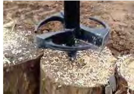
Die einzigartige Zentrierspitze bohrt sich in die Oberfläche des Baumstumpfs und zieht dann den Fräsbohrer nach unten.
