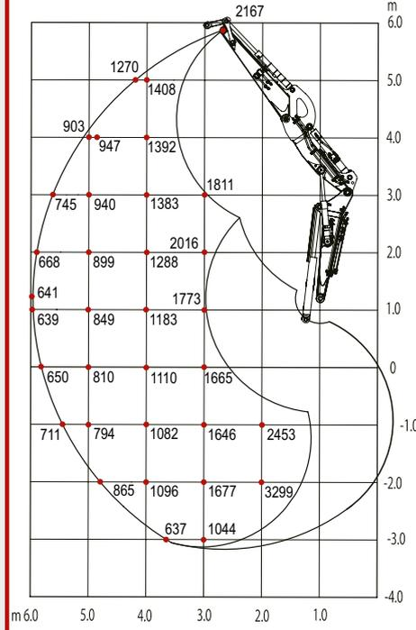
Die Hublasten in den Grafiken betragen bis zu 87% der hydraulischen Hublast bzw. bis zu 75% der Kipplast. Die Werte sind in Kilogramm angegeben – ohne Powerlift. Technische Änderungen vorbehalten.
