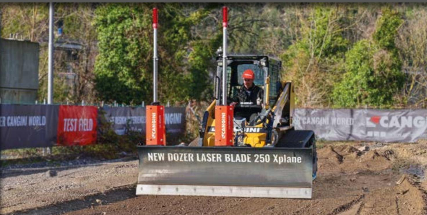
DAS MIT 2 LASEREMPFÄNGERN AUSGESTATTETE PLANIERSCHILD STEUERT AUTOMATISCH UND PRÄZISE DIE HÖHE UND DIE NEIGUNG DES SCHILDES UND ERMÖGLICHT DAMIT DAS EXAKTE PLANIEREN GROSSER FLÄCHEN WIE Z.B. BEI ERSTELLUNG VON INDUSTRIEHALLEN, LAGERGEBÄUDEN, SPORTSTÄTTEN SOWIE IM GALABAU. DAS BEDIENTERMINAL IN DER KABINE ÜBERTRÄGT DIE BEFEHLE ÜBER **KABELLOSE** KOMMUNIKATION AN DEN SCHLTKASTEN. DADURCH KANN DIE KABINE GESCHLOSSEN WERDEN, OHNE DASS IRGENDWELCHE KABEL IM WEG SIND.
