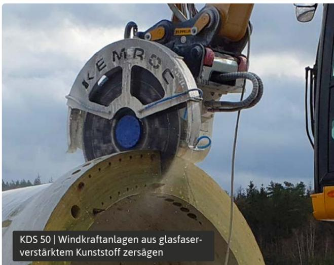
KDS 50 | Windkraftanlagen aus glasfaserverstärktem Kunststoff zersägen
