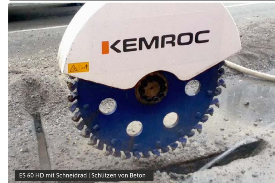
ES 60 HD mit Schneidrad | Schlitzen von Beton
