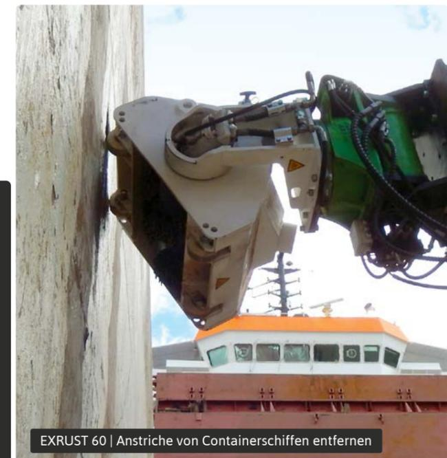
EXRUST 60 | Anstriche von Containerschiffen entfernen
