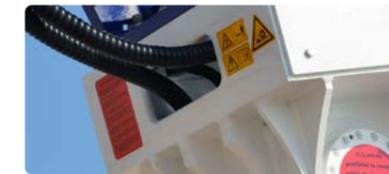
Spezielle Konsole zum Schutz der Hydraulikschläuche
