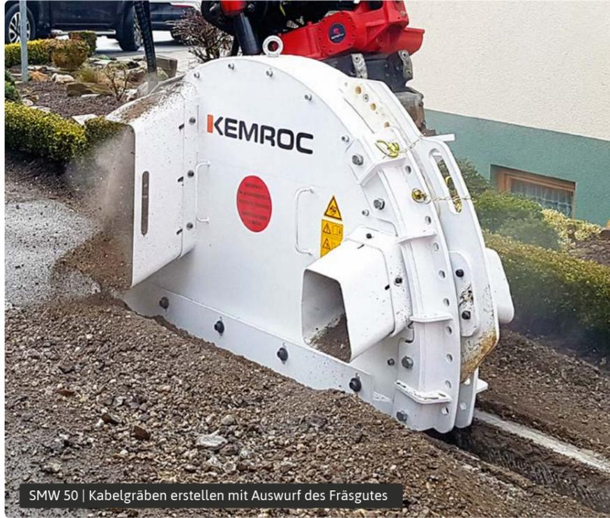
SMW 50 | Kabelgräben erstellen mit Auswurf des Fräsgutes
