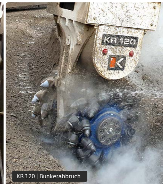
Spezielle Konsole zum Schutz der Hydraulikschläuche
