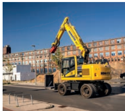
Laststabilisator für Ausleger (ECSS) für mehr Fahrerkomfort
