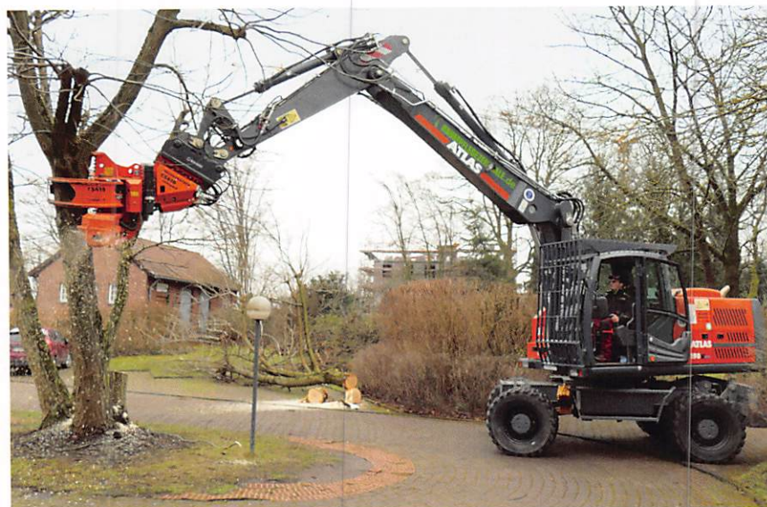
Auch ohne Pratzenabstützung ist der Mobilbagger 190W äußerst standfest, er arbeitet mit enormer Kraft sowie auch hydraulischem Feingefühl. (Bild: Atlas)
