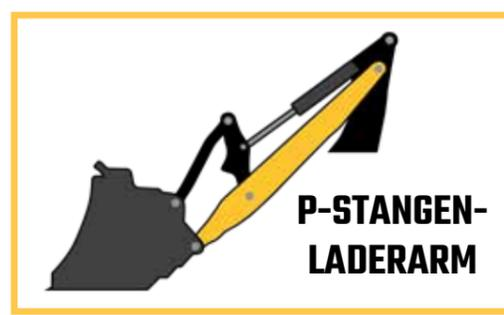
Der AL530 ist der größte unserer Lader mit dem P-Kinematik-Laderarm und genau für Ihre Anforderungen gebaut. Mit einer statischen Kipplast bei gerader Schaufel von 1880 kg und einer Höhe des Schaufeldrehpunkts von 3,07 m, hat diese Maschine die perfekte Größe für jede Aufgabe, ob groß oder klein.
