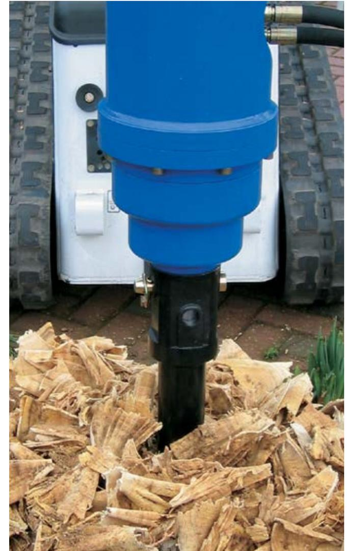
Die Baumstumpfentfernung ist mit unserem Fräsbohrer sauber und leise; sie kann von einer einzigen Person effektiv ausgeführt werden.
