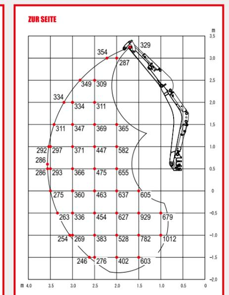
Die Hublasten in den Grafiken betragen bis zu 87 % der hydraulischen Hublast bzw. bis zu 75 % der Kipplast. Die Werte sind in Kilogramm angegeben – ohne Powertilt. Technische Änderungen vorbehalten.
