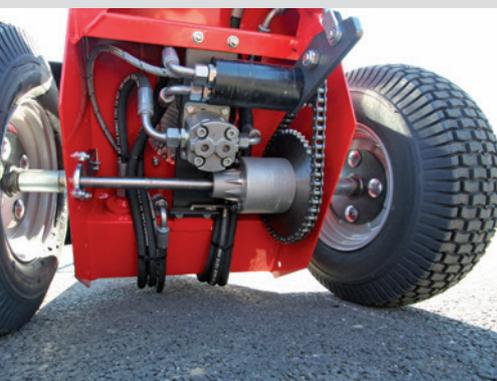
Hydrostatischer, Stufenloser Fahrtrieb mit Differenzialachse
