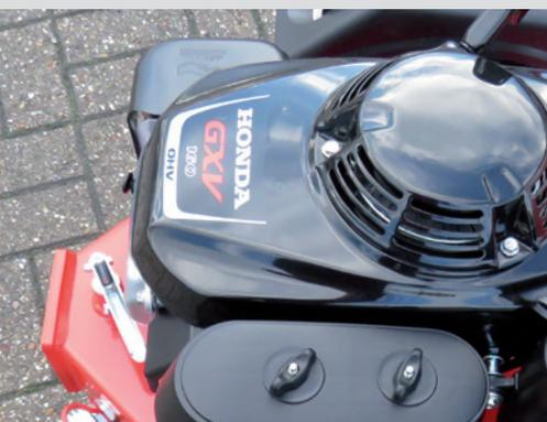
Leistungsstarker Honda-Industriemotor mit 4,4 PS (Nettoleistung)
