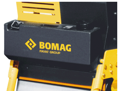
Kein Anhaften auf Asphalt Wasserberieselung mit großem Wassertank (standard)
