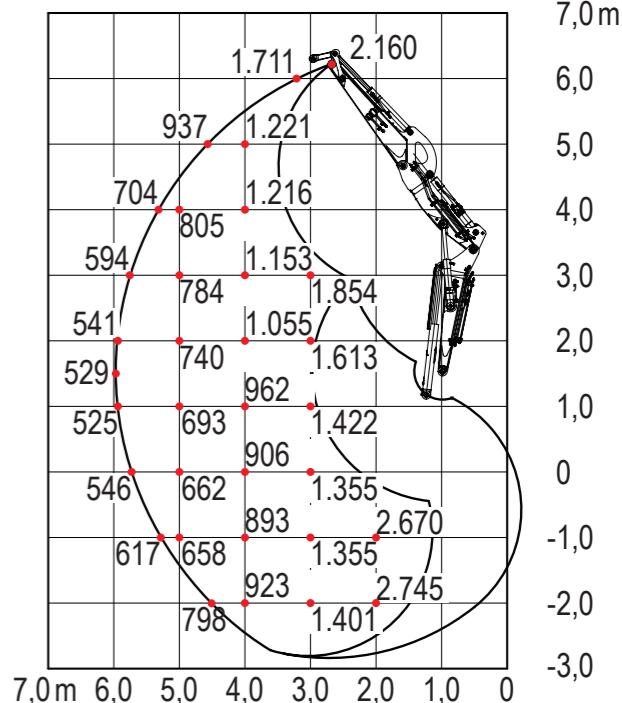
Die Hublasten in den Grafiken betragen bis zu 87 % der hydraulischen Hublast bzw. bis zu 75 % der Kipplast. Die Werte sind in Kilogramm angegeben – basierend auf der Basisausstattung ohne Powertilt oder Tiltrotator. Technische Änderungen vorbehalten.
