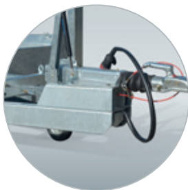
Zubehör: Kupplungserhöhung von 5 oder 10 cm
