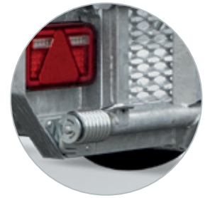
Heckklappe mit Torsionsfedern
