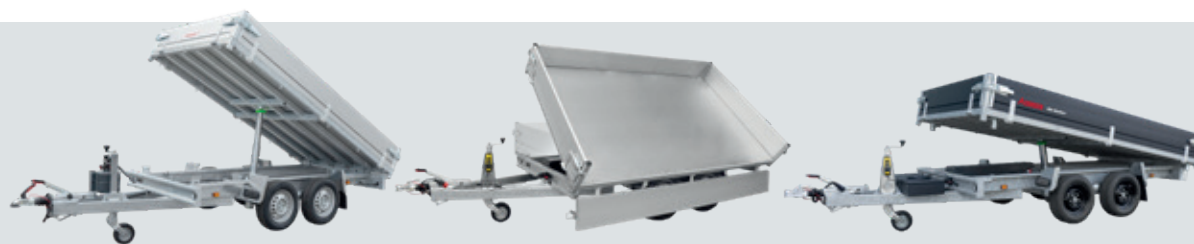
KSX Rückwärtskipper oder 3-Seitenkipper Handpumpe
