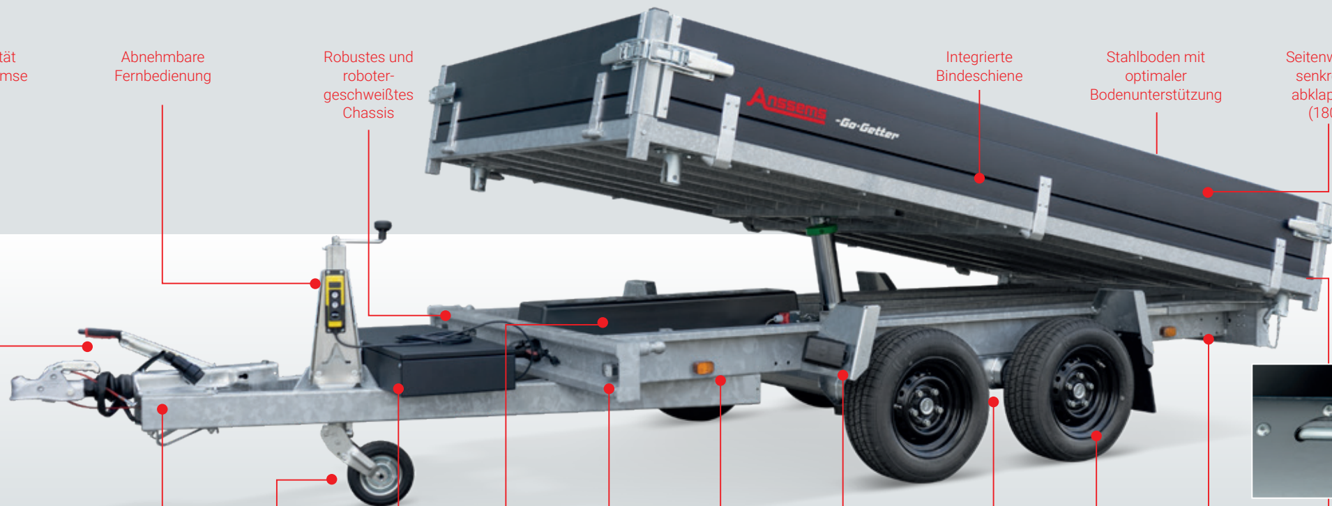
Lange Deichsel aus Rechteckrohrprofilen
